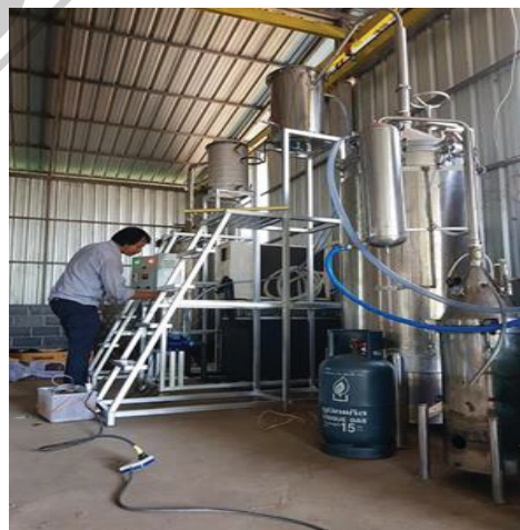
Figure 1 เครื่องกลั่นน้ำมันหอมระเหยแบบกลั่นด้วยน้ำและไอน้ำ ขนาด 500 liter
