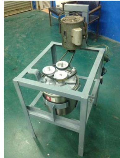
(d) Prototype of the lotus seed membrane peeling machine.
