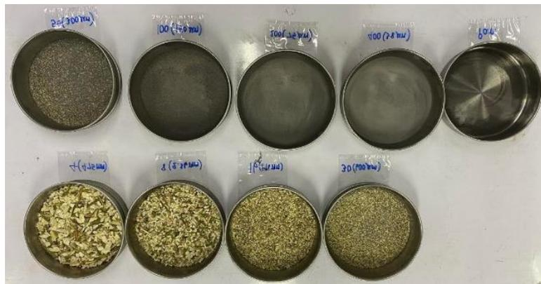
ภาพที่ 3 วัสดุที่ตกค้างบนตะแกรงแต่ละขนาดจากวิธีการร่อนผ่านตะแกรง
