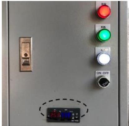
รูปที่ 2.3 อุณหภูมิและความชื้นสัมพัทธ์จากหน้าจอที่วัดค่าได้จากเซนเซอร์ DHT11
