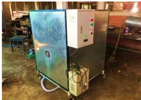
รูปที่ 3.1 ผลการสร้างชุดทดสอบเพาะเห็ดนางฟ้า
