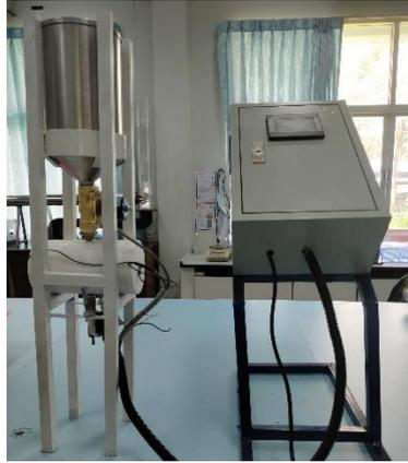
ภาพที่ 1 เครื่องพาสเจอร์ไรซ์น้ำมะพร้าวด้วยโอห์มมิก ประกอบด้วย ถังเก็บวัตถุดิบ, โอห์มมิกเซลล์ และชุดควบคุมอุณหภูมิ แรงดันไฟฟ้าด้วย PLC
