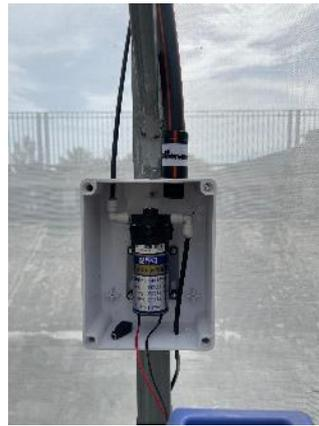
ภาพที่ 2 (ซ้าย) เครื่องสูบน้ำสำหรับระบบพ่นหมอก และ (ขวา) การติดตั้งในโรงเรือน
