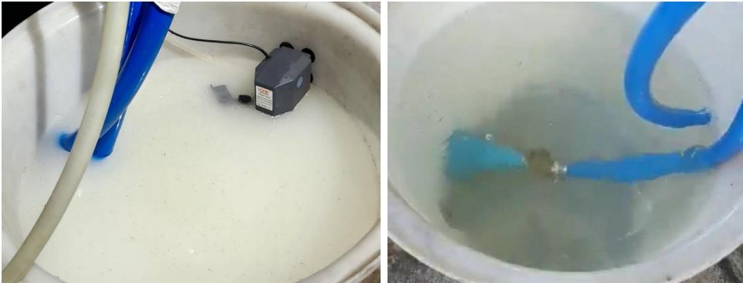
ภาพที่ 4 เปรียบเทียบระหว่างน้ำไมโครบับเบิลและน้ำเปล่า
