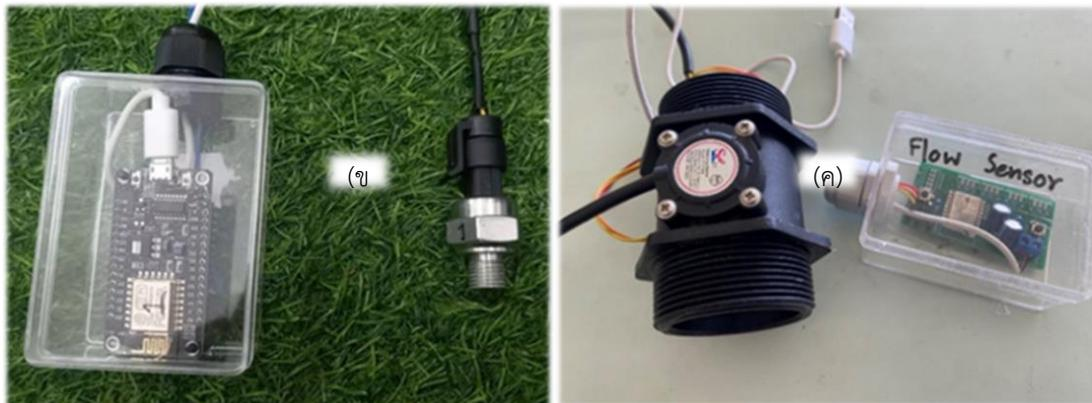
(ก) การเชื่อมต่อช่องสัญญาณของเซนเซอร์กับบอร์ดไมโครคอนโทรลเลอร์ (ข) Pressure Sensor และ (ค) Water Flow Sensor
