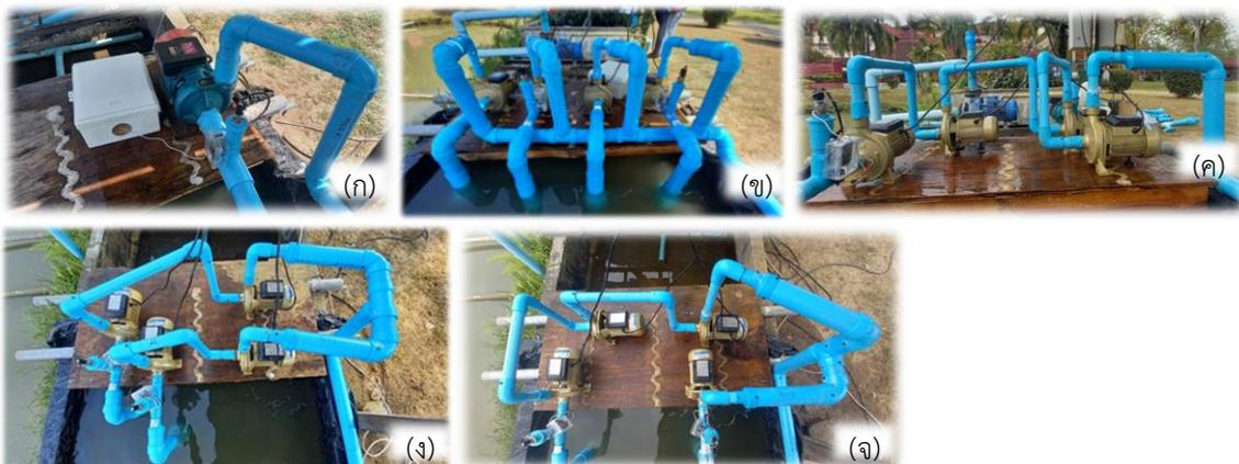
(ก) สูบน้ำเข้าสู่ท่อให้ได้ระดับตามที่กำหนด (ข) การติดตั้งเครื่องสูบน้ำในรูปแบบขนาน (ค) การติดตั้งเครื่องสูบน้ำในรูปแบบอนุกรม
