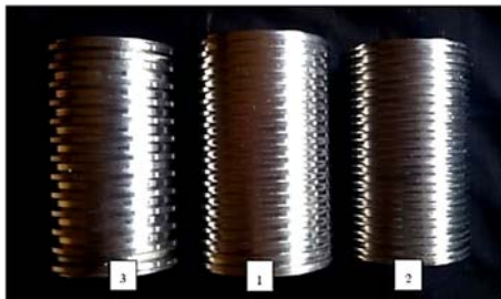
รูปที่ 11 หัวรีดแบบเกลียว ชิ้นงานจริง
